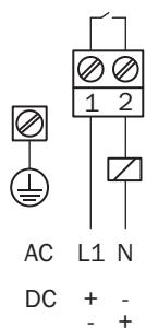
Anschlussart LFV300 Kontaktloser Schalter - Elektronikeinsatz
