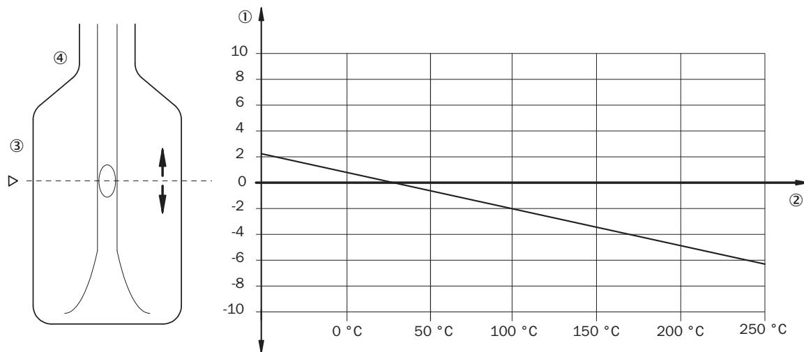
① Verschiebung des Schaltpunktes in mm (in)
