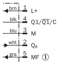
① Multifunktionseingang/Synchronisations- und Multiplexbetrieb/Kommunikation Connect+
