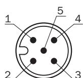
Anschlusschema UM18-21xxxCxxx\_Dxxx Stecker M12, 5-polig
