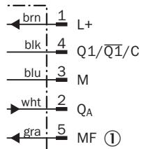
① Multifunktionseingang/Synchronisations- und Multiplexbetrieb/Kommunikation Connect+
