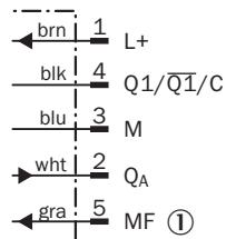
① Multifunktionseingang/Synchronisations- und Multiplexbetrieb/Kommunikation Connect+
