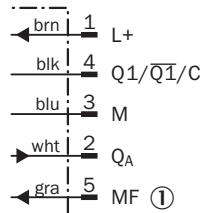
① Multifunktionseingang/Synchronisations- und Multiplexbetrieb/Kommunikation Connect+
