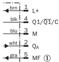
① Multifunktionseingang/Synchronisations- und Multiplexbetrieb/Kommunikation Connect+
