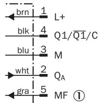
① Multifunktionseingang/Synchronisations- und Multiplexbetrieb/Kommunikation Connect+
