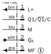
① Multifunktionseingang/Synchronisations- und Multiplexbetrieb/Kommunikation Connect+
