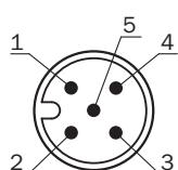
Anschlusschema UM18-21xxxCxxx\_Dxxx Stecker M12, 5-polig
