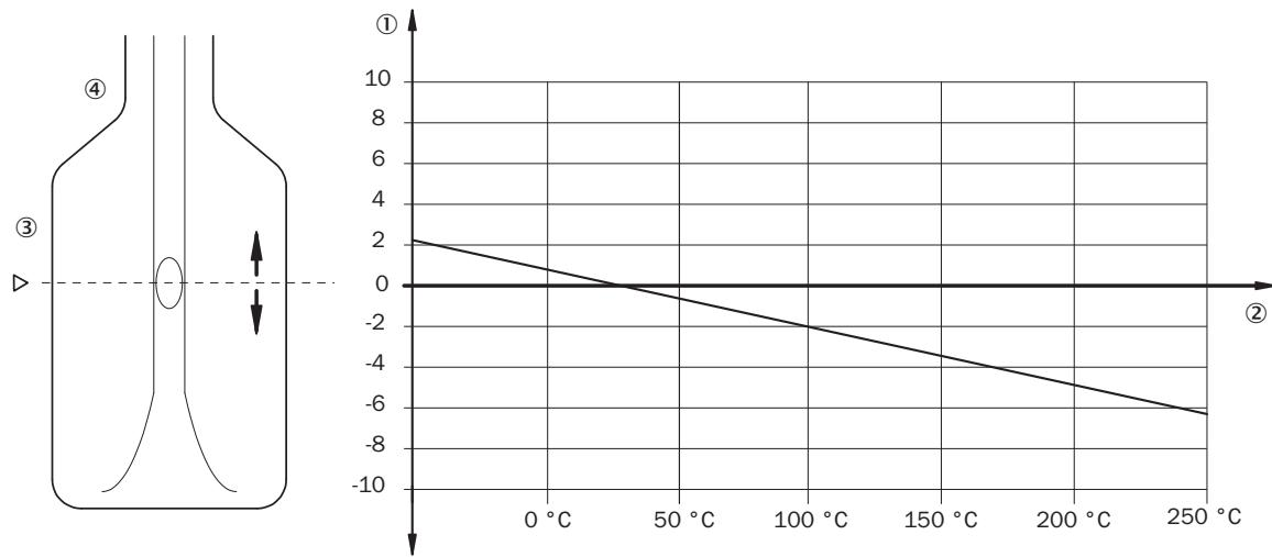
① Verschiebung des Schaltpunktes in mm (in)
