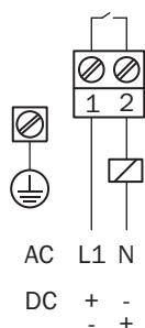
Anschlussart LFV300 Kontaktloser Schalter - Elektronikeinsatz
