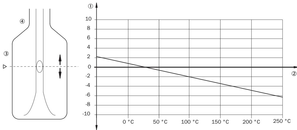
① Verschiebung des Schaltpunktes in mm (in)
