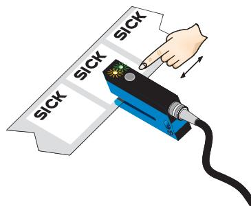
T-Taste < 20 s loslassen. Bei erfolgreichem Teach-in zeigt die Funktionsanzeige (gelbe LED) direkt den Schaltzustand des Sensors an. Die Schaltschwelle ist nun optimal zwischen Träger und Etikett gesetzt. Die bestmögliche Betriebssicherheit ist gegeben.
