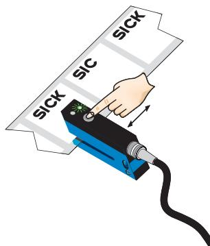
T-Taste 3 - 20 s drücken. Bei gedrückter Taste mehrere Etiketten mit Trägermaterial (zu detektierende Etikette) durch den Sensor bewegen. Während des Teach-in Vorgangs blinkt die gelbe LED mit 3Hz. Empfehlung: Mindestens 3 Etikette durch den Sensor bewegen.
