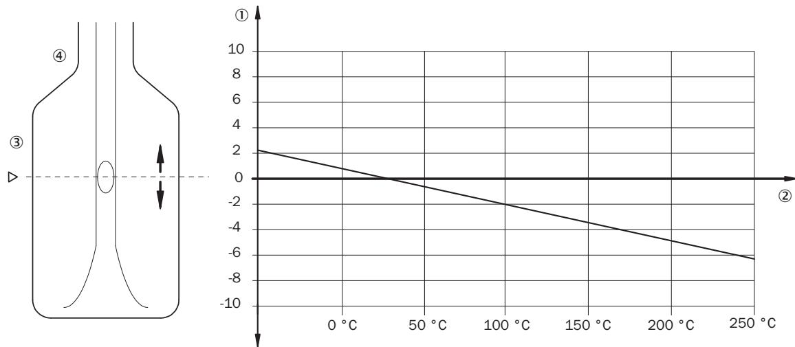
① Verschiebung des Schaltpunktes in mm (in)
