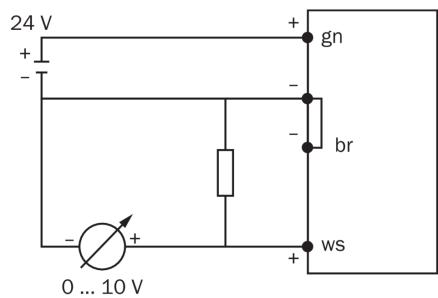
für eine genaue Messung, muss der Innenwiderstand der Messeinrichtung 10 kOhm betragen.
