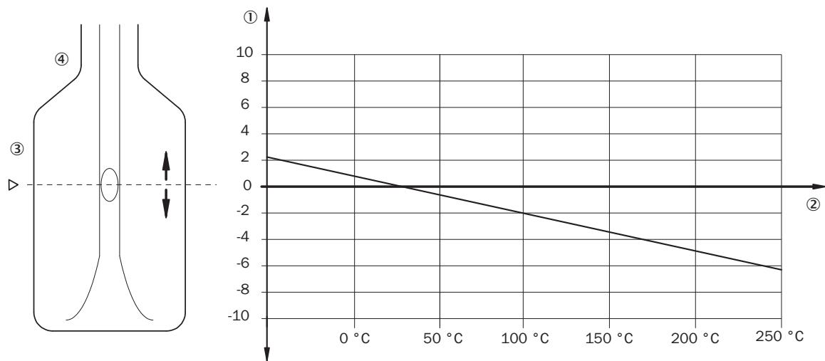
① Verschiebung des Schaltpunktes in mm (in)
