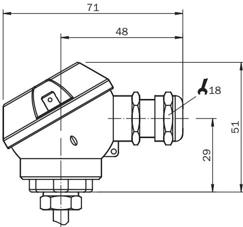
Anschlussart Leitungsdurchführung M16 x 1,5, Leitungsquerschnitt bis 0,75 mm<sup>2</sup>, Ausgangssignal Pt100
