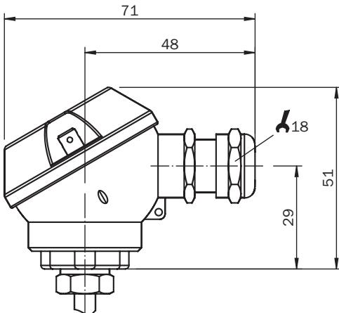
Anschlussart Leitungsdurchführung M16 x 1,5, Leitungsquerschnitt bis 0,75 mm<sup>2</sup>, Ausgangssignal 4 mA ... 20 mA
