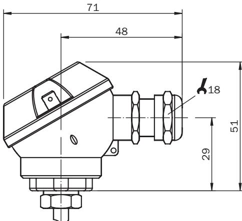
Anschlussart Leitungsdurchführung M16 x 1,5, Leitungsquerschnitt bis 0,75 mm<sup>2</sup>, Ausgangssignal Pt100
