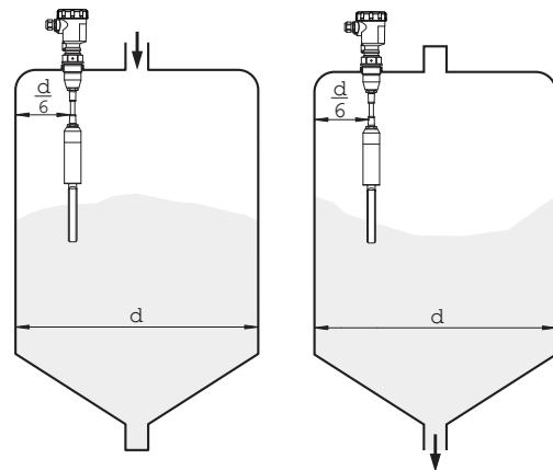
Montagehinweise Strömungsausrichtung der Schwinggabel
