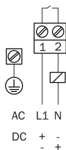
Anschlussart LFV300 Kontaktloser Schalter - Elektronikeinsatz
