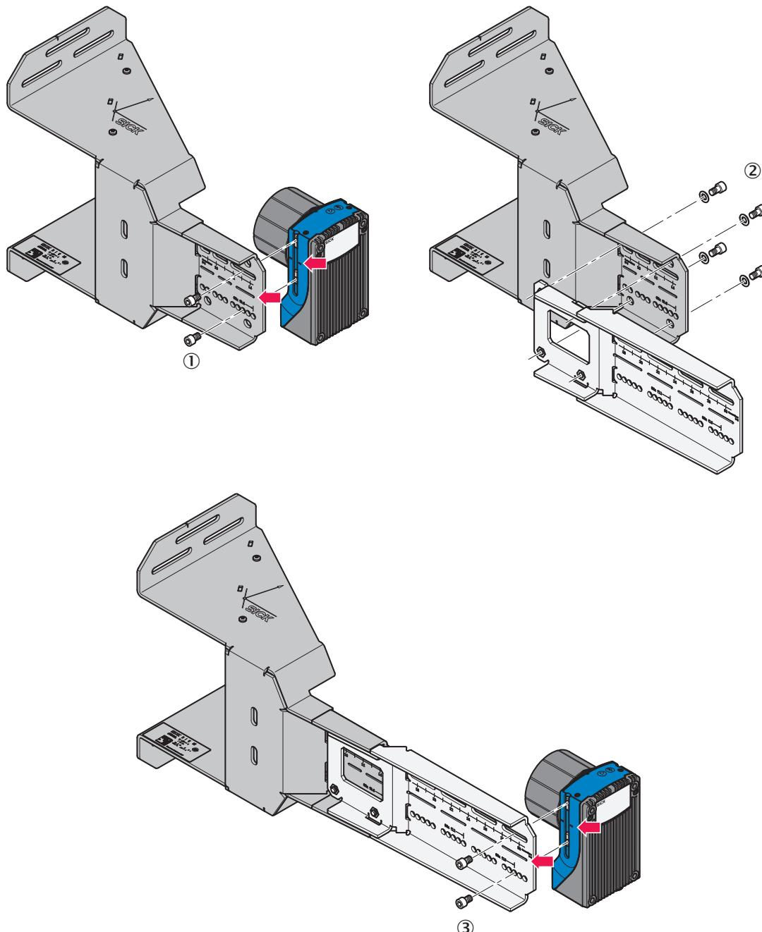
① Nutzung ohne Verlängerung: Lector in gewünschtem Abstand am Umlenkspiegel festschrauben (siehe aufgedruckte Messskala), dabei auf die vertikale Ausrichtung achten (schmales Langloch und Markierung am Lector, siehe rote Pfeile)
