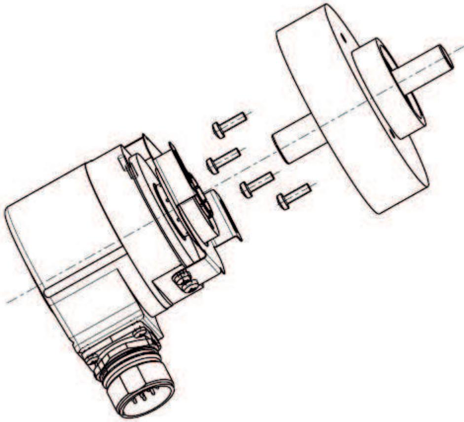
Die Montage des Lagerbocks erfolgt über die stirnseitigen Gewindebohrungen oder mit Hilfe eines Flanschadapters (Bestell Nr. 2029162) bzw. eines Montagewinkels (Bestell-Nr. 2029164).
