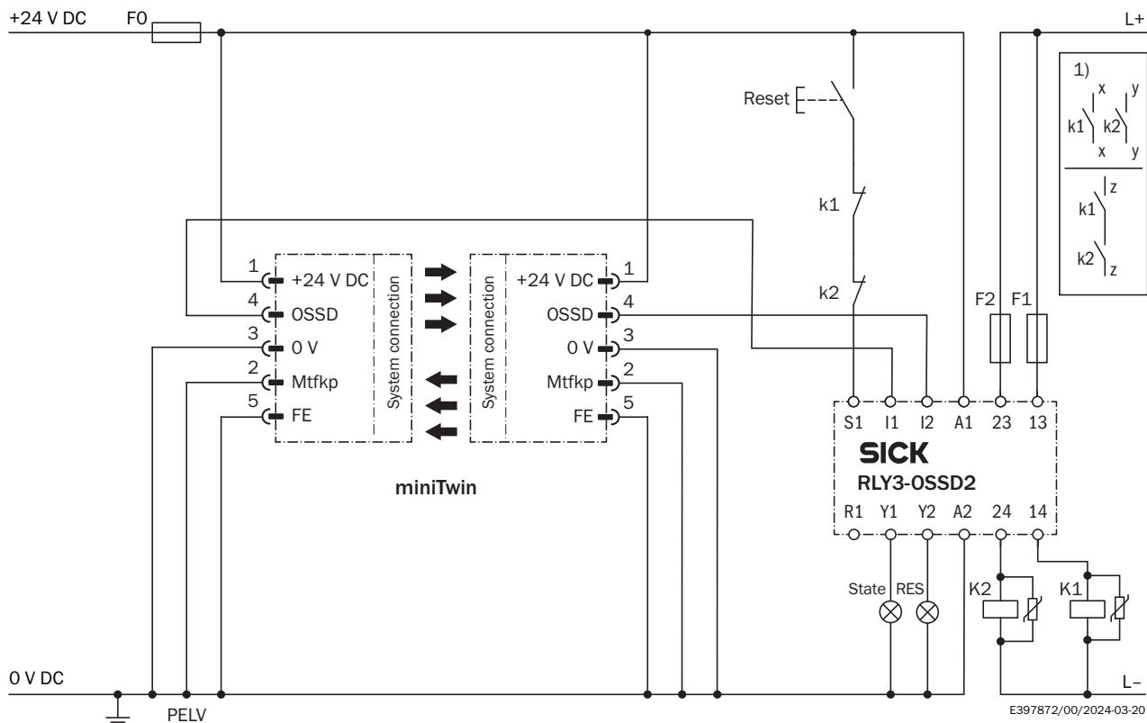
① Ausgangskreise: Diese Kontakte müssen in die Steuerung so eingebunden werden, dass bei geöffnetem Ausgangskreis der Gefahr bringende Zustand aufgehoben wird. Bei den Kategorien 4 und 3 muss diese Einbindung zweikanalig (x-, y-Pfade) erfolgen. Das einkanalige Einfügen in die Steuerung (z-Pfad) ist nur bei einkanaliger Steuerung und unter Berücksichtigung der Risikoanalyse möglich.
