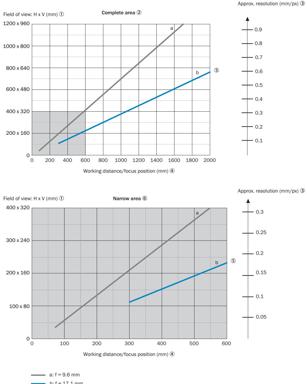
Bei der Applikationsauslegung sind folgende Aspekte zu berücksichtigen: Sichtfeldgeometrie des Geräts und Lage des Sichtfelds im Raum vor dem Gerät. Mögliche Winkel, in denen die Objekte in Bezug auf das Gerät auftreten können. Für den geplanten Arbeitsabstand: resultierende Sichtfeldlänge und -breite sowie die ungefähre Auflösung.
