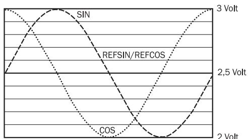
Signalverlauf bei Drehen der Welle im Uhrzeigersinn mit Blick in Richtung "A" (siehe Maßzeichnung)
