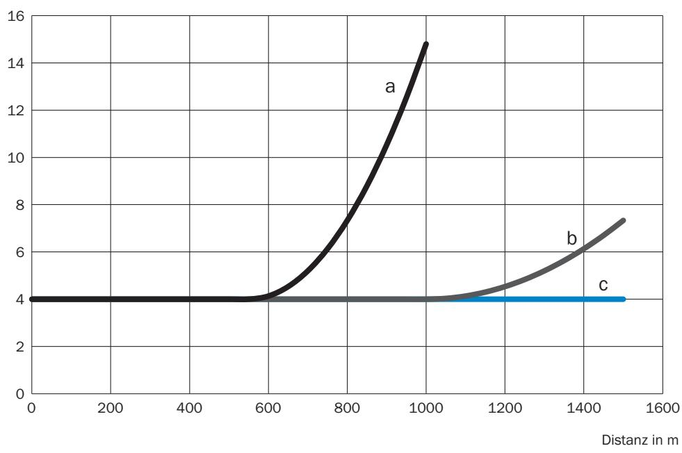
Messgenauigkeit Typisch DL1000, x-Achse: Distanz, y-Achse: typ. Messgenauigkeit
