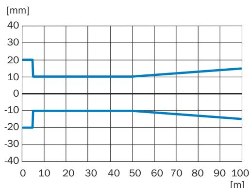
Messgenauigkeit Typisch DL1000, x-Achse: Distanz, y-Achse: typ. Messgenauigkeit
