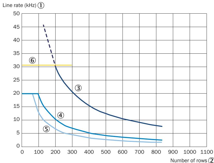
die maximale Linienrate in Abhängigkeit von der Anzahl der verwendeten Sensorzeilen
