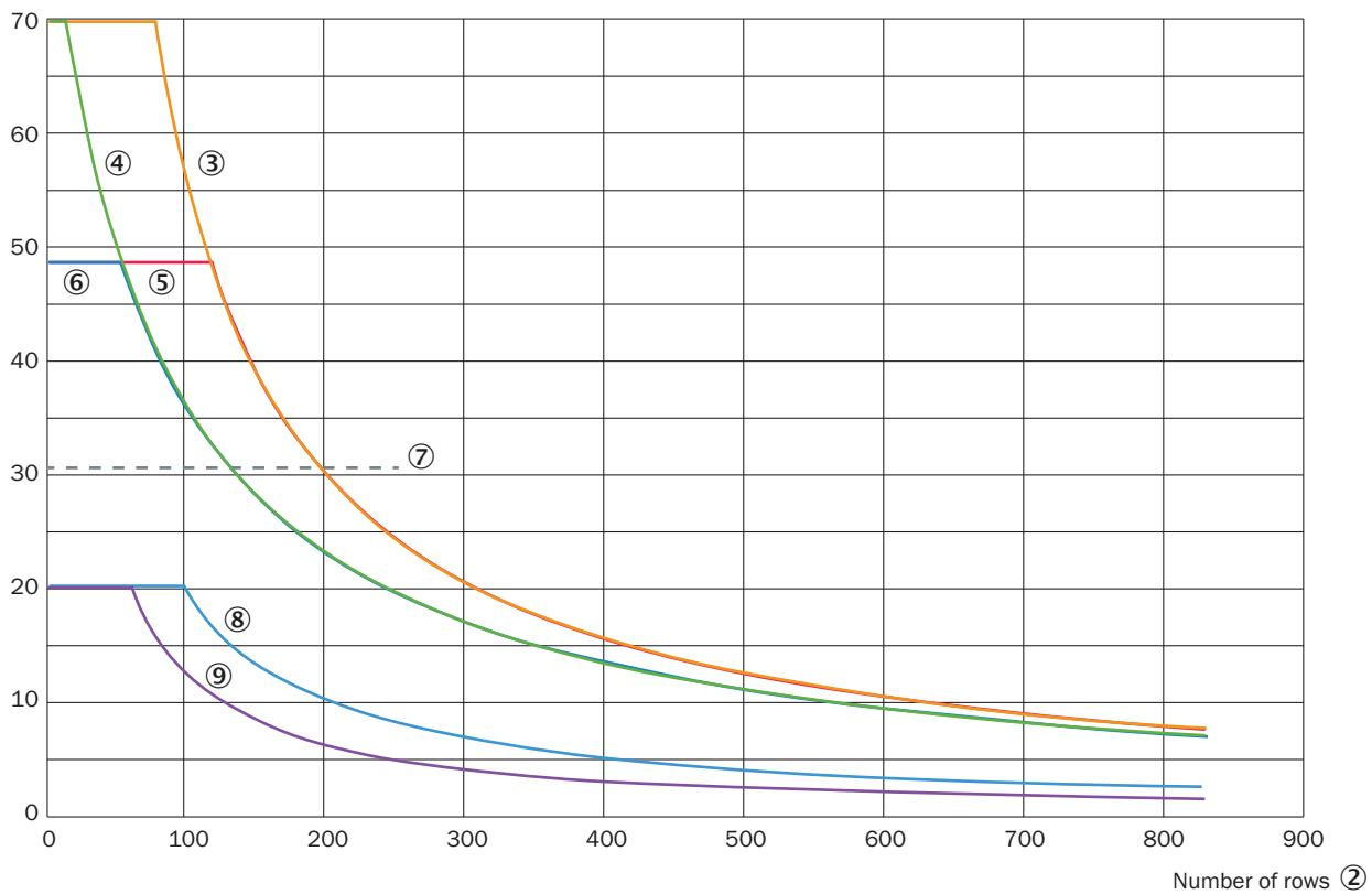
die maximale Linienrate in Abhängigkeit von der Anzahl der verwendeten Sensorzeilen
