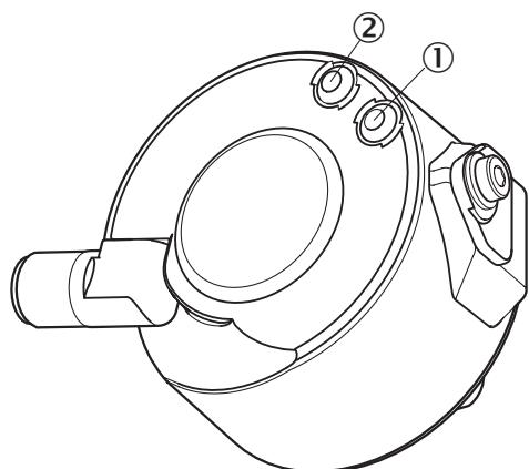
DIP-Schalter Konfiguration B - 2048 Impulse
