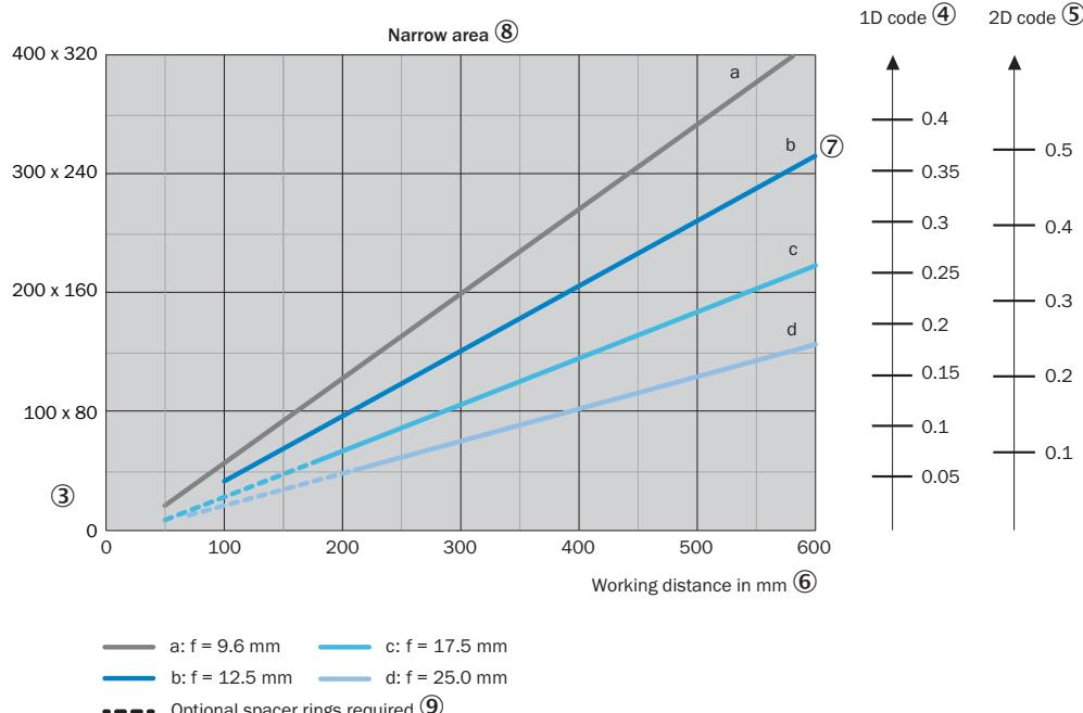
Für S-Mount- und Standard-C-Mount-Objektive werden Distanzringe für Arbeitsabstände von weniger als etwa 10 mal der Brennweite benötigt.
