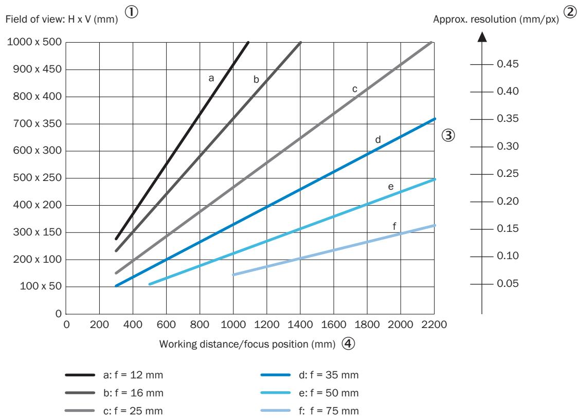
① Sichtfeld: horizontal x vertikal in mm
