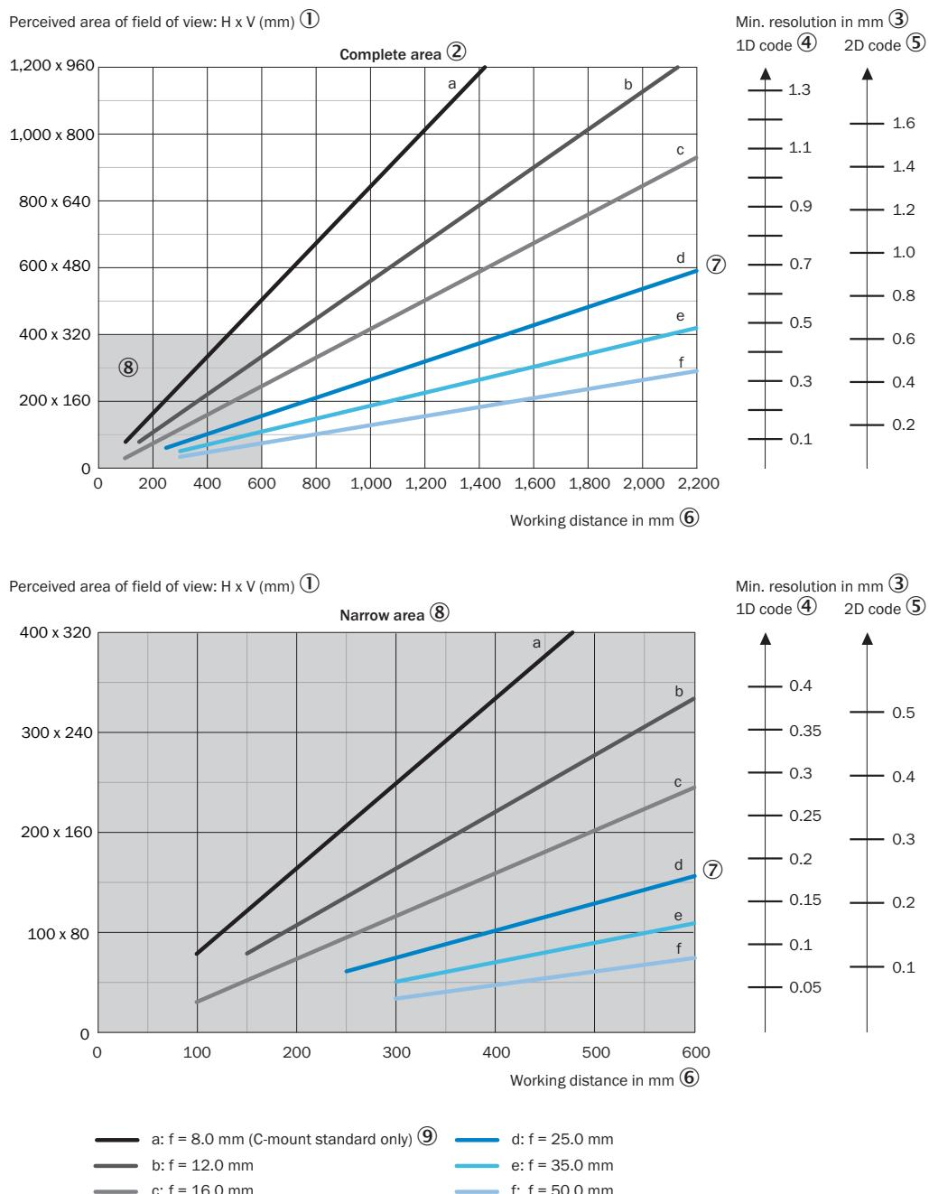
Für S-Mount- und Standard-C-Mount-Objektive werden Distanzringe für Arbeitsabstände von weniger als etwa 10 mal der Brennweite benötigt.
