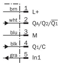
PIN-Belegung Stecker M12, 5-polig, A-codiert
