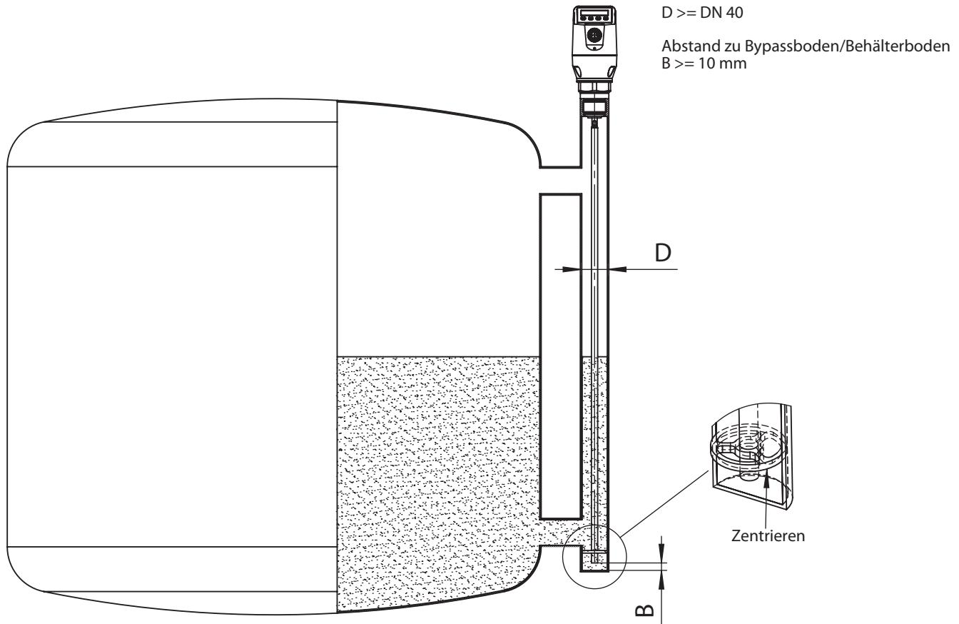
Montagehinweise Einbau in einen metallischen Behälter
