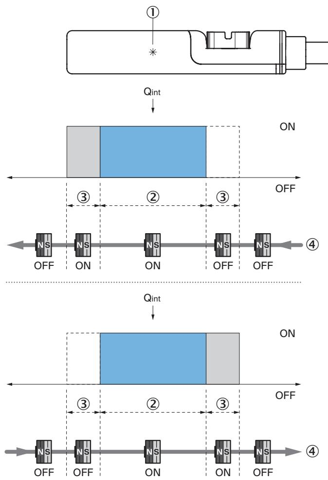
Hinweis: Sensorgehäuse kann abweichen; Darstellung entspricht Ausgangsfunktion „Schließer“; Überfahrweg = Schaltpunktbreite + Hysterese
