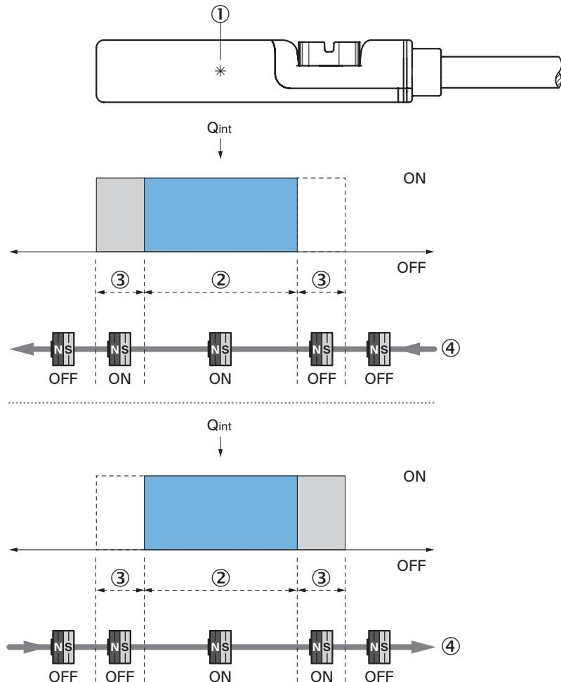
Hinweis: Sensorgehäuse kann abweichen; Darstellung entspricht Ausgangsfunktion „Schließer“; Überfahrweg = Schaltpunktbreite + Hysterese
