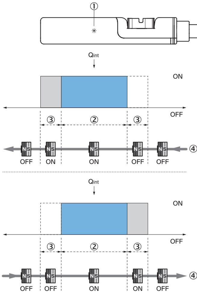
Hinweis: Sensorgehäuse kann abweichen; Darstellung entspricht Ausgangsfunktion „Schließer“; Überfahrweg = Schaltpunktweite + Hysterese
