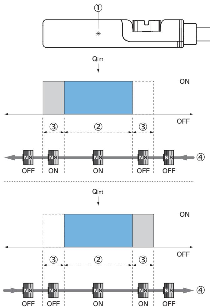
Hinweis: Sensorgehäuse kann abweichen; Darstellung entspricht Ausgangsfunktion „Schließer“; Überfahrweg = Schaltpunktbreite + Hysteresee
