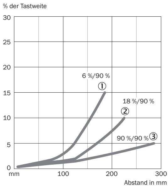
Schaltabstand-Diagramm WTB4S-3, Schaltabstand 280 mm
