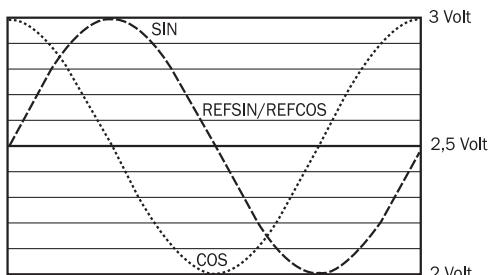
Signalverlauf bei Drehen der Welle im Uhrzeigersinn mit Blick in Richtung "A" (siehe Maßzeichnung)
