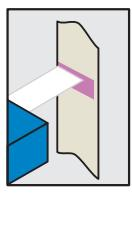
Drehschalter „Sensitivity“ nach rechts drehen, bis gelbe LED leuchtet.
