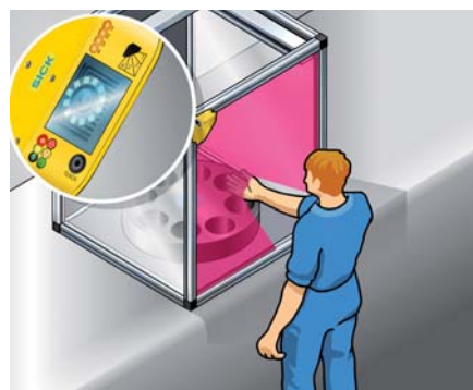
Protection des points dangereux sur une machine d'assemblage semi-automatique
