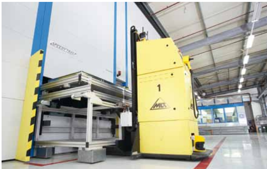
Die Zielsetzung der sicheren Laserscanner mit CMS-Funktion – hier der S3000 – ist die gleichzeitige Übernahme absichernder und navigationsunterstützender Funktionen durch einen einzigen Sensor
