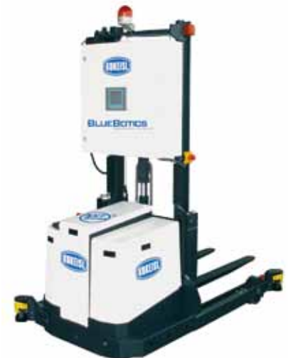
Der KOKEISL Picking Robot bewegt sich fahrerlos und autonom durch den Pro- duktionsbetrieb
