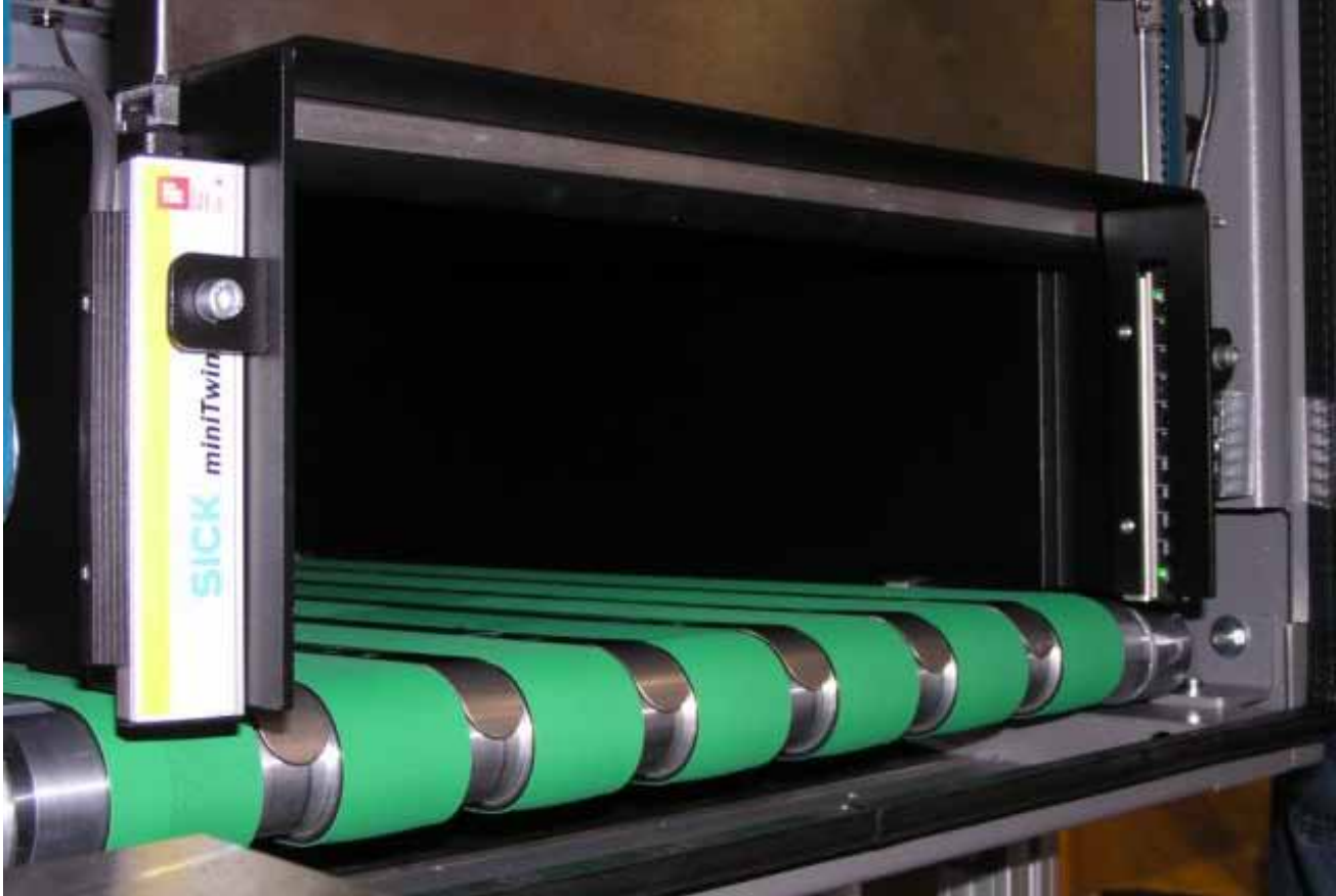
Beim miniTwin2 entsteht das Lichtgitter durch eine um 180° verdrehte Montage von zwei miniTwin-Sticks zueinander, so dass sich die Sender- und die Empfängermodule gegenüber befinden
